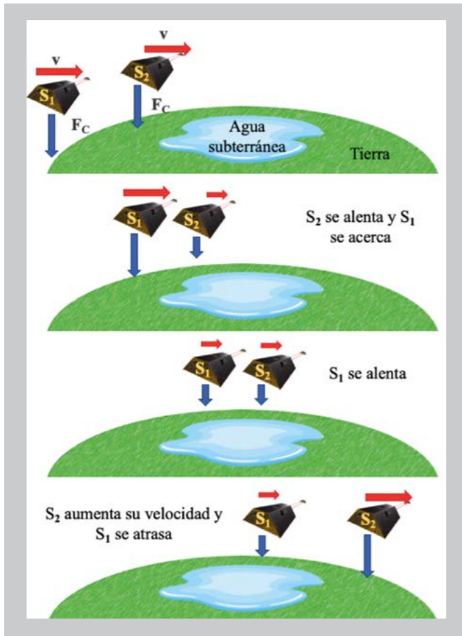
Figura 2. Etapas del sobrevuelo de los satélites gemelos para detectar anomalías gravitacionales. Nótese que a mayor masa debajo del satélite (y mayor F_c ) hay una mayor velocidad.
